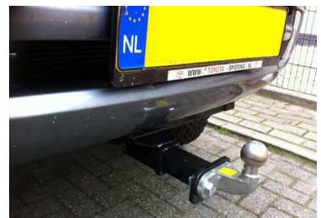
Afbeelding 4: De 2" receiver koppeling kan ook gebruikt worden als trekhaak aan de voorzijde (optie)
