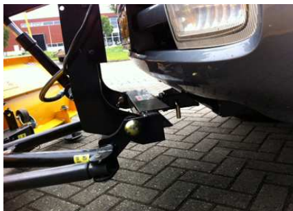
Afbeelding 1: Voertuigadapter steekt niet uit
