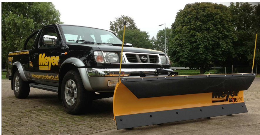
Afbeelding 1: Nissan Navara (2000) met DrivePro 6.8 met hydraulische bediening en stuifkap.
