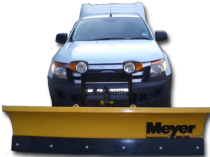
Afbeelding 1: Ford Ranger 2012 model met DrivePro 6.8 met hydraulische bediening en Nite Saber verlichting.
