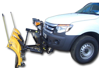
Afbeelding 1: Ford Ranger 2012 model met DrivePro 6.8 met hydraulische bediening en Nite Saber verlichting.
