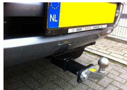
Afbeelding 5: De 2" receiver koppeling kan ook gebruikt worden als trekhaak aan de voorzijde (optie)
