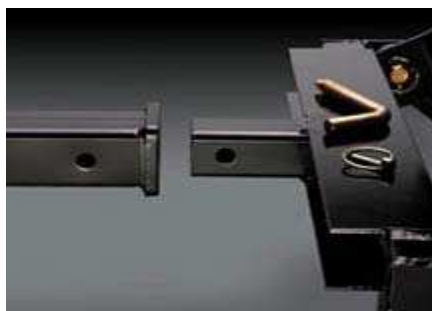
Afbeelding 4: De 2" receiver koppeling, licht in gewicht.
